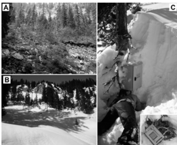
Fig. 7.1 - L'éboulis de Dreveneuse d'en Bas et sa forêt d'arbres nains en été (A) et en hiver (B). L'installation d'un profil fixe ERT permet de réaliser les mesures même en présence d'un épais manteau neigeux (environ 3m sur la photo C du 16 mars 2009) (photo : D. SCIBOZ). Le tableau de connexion du profil fixe ERT se trouve 1m sous l'armoire du forage F1 visible sur la photo (elle-même se trouvant normalement à 1.6m de hauteur).
