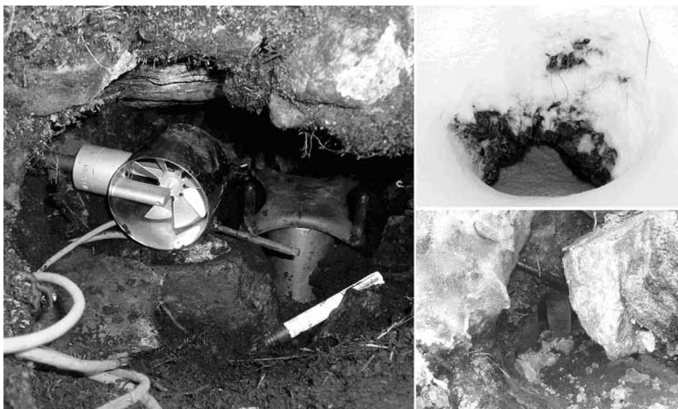
Fig. 3.3 - Equipement du trou à vent du Gros Chadoua avec anémomètres à ailettes et sonique, capteur de température et d'humidité en juillet 2007. A droite, le même trou en début d'hiver après une phase d'aspiration de neige profonde à l'intérieur du trou, et au printemps lors du regel des eaux de fonte de la neige.
