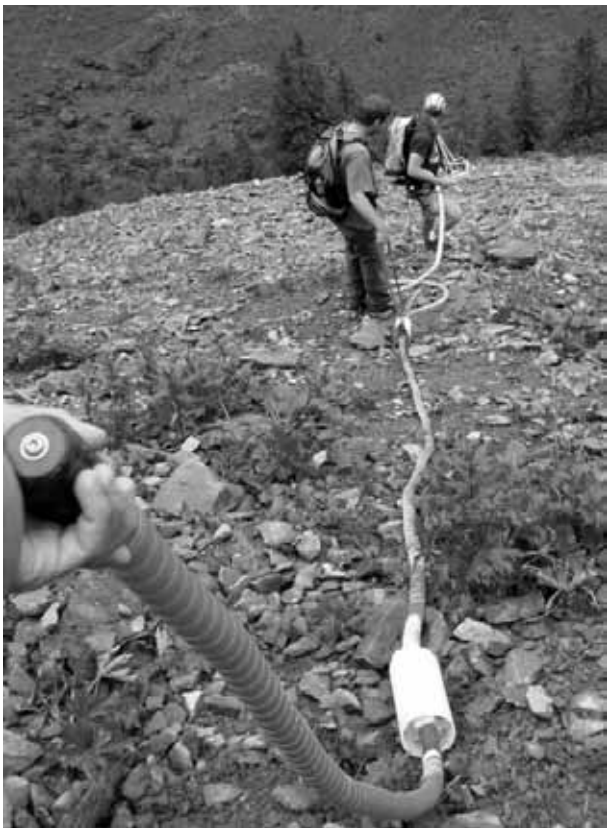
Fig. 3.15 - Ramac Rough Terrain Antenna à 25 MHz de Mala Geosciences. L'impulsion est donnée chaque 50cm par un opérateur. La distance entre l'antenne (boîtes blanches sur la photo) transmetteur et récepteur est fixe.
