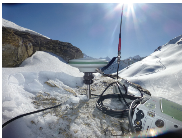
Figure 2 - Aujourd'hui, un ancrage permanent remplace l'utilisation du trépied au col du Louché : du poids économisé, du temps gagné et de la précision grignotée.
