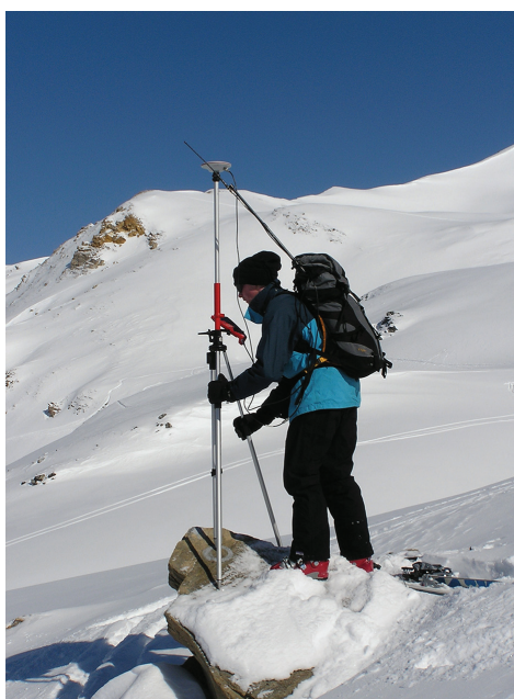
Figure 2 - Aujourd'hui, un ancrage permanent remplace l'utilisation du trépied au col du Louché : du poids économisé, du temps gagné et de la précision grignotée.
