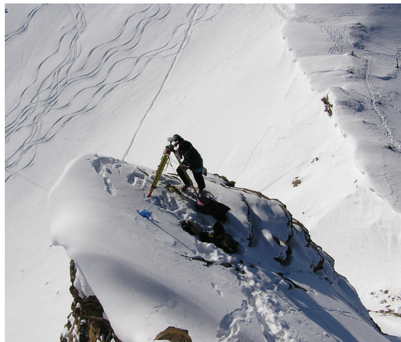
Figure 1 - Dans certains secteurs, trouver un emplacement stable et aisément accessible pour l'implantation d'une base locale n'est pas toujours aisé (ici, station de référence du col du Louché, glacier rocheux des Becs-de-Bosson, 46°10'20"N, 07°30'50"E).
