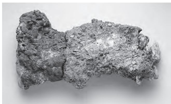
Fig. 64 Scorie en forme de calotte. Des traces de paroi argileuse s'observent à chaque extrémité. L. = 14,9 cm.
